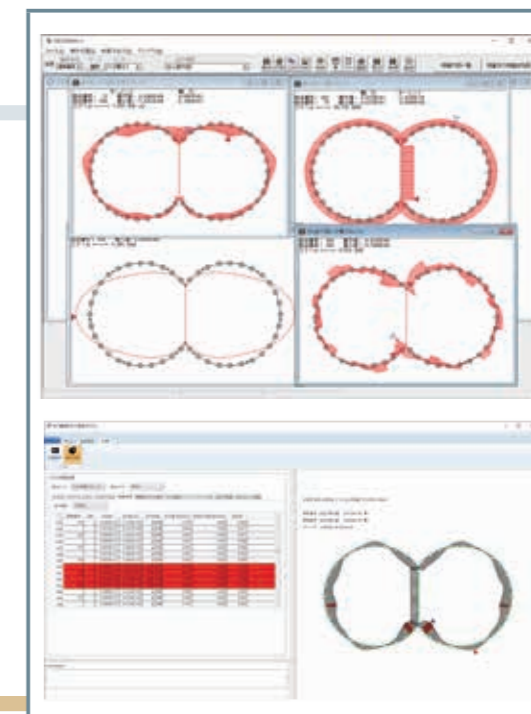
シールドトンネルの変位・応力計算と応力照査例
