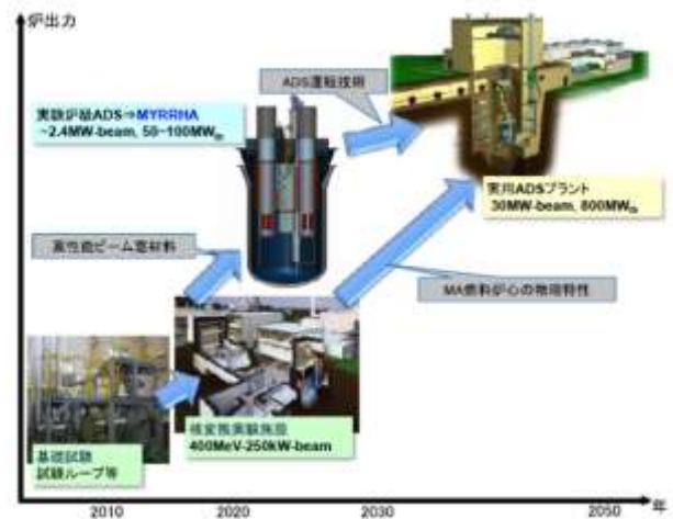
図3 加速器駆動システムを用いた核変換技術のロードマップ 2)
