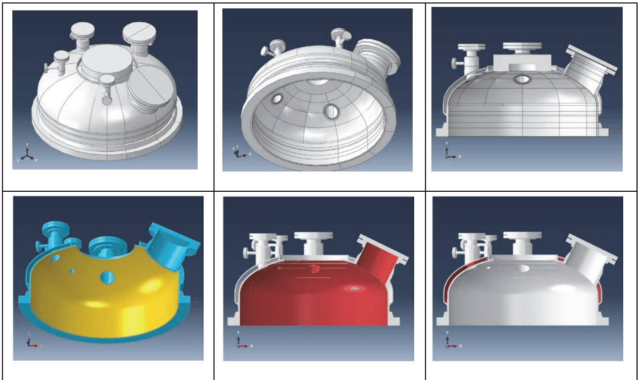
図3 解析対象の形状 上段左から、俯瞰図、下から見た図、断面図 下段左から、クラッド（黄色）と母材（青色）、压力容器内表面（赤色）、ジャケット内表面（赤色）
