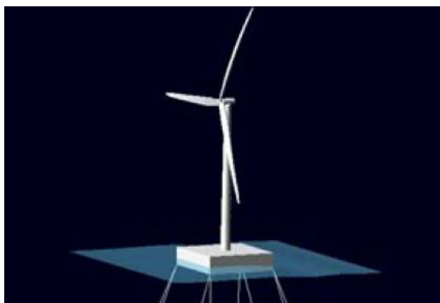
図 5 IEA-5MW-Barge 型浮体 概要図 7)
