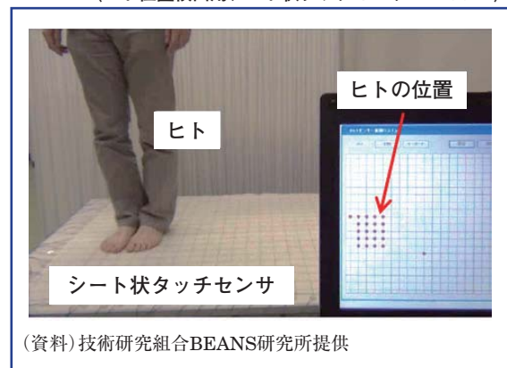
図表8 大面积フレキシブルデバイス試作例 (ヒト位置検出用シート状タッチセンサ:1mX1m)
