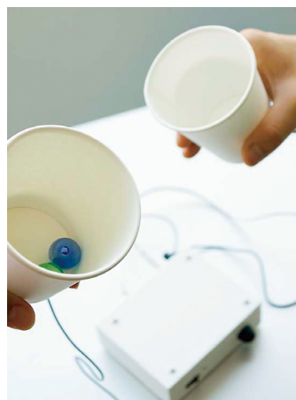
図表2 「TECHTILE toolkit」を用いた触覚の取得・記録・伝達・再現
